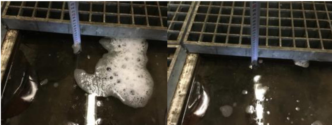
Abbildung: Dichtheitsprobe: Wasserstand am 12.05.2017 (links) und am 15.05.2017 (rechts)
