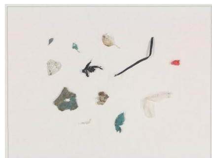
Bildaufnahme der gesammelten Kunststofffragmente eines Quadratmeters auf definierter Fläche zur Ermittlung der Flächensumme
