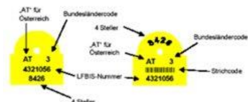
Abbildung 1: Gestaltung der Ohrmarke für Schweine gemäß § 22
