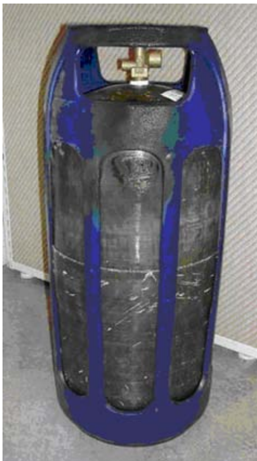
Bild D.7 — Wärme- und Brandschäden
